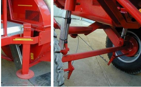
Durch die hydraulische Anhebung wird beim Strassentransport eine grosse Bodenfreiheit erreicht.
