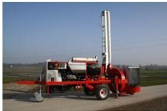
Die Rohrleitung wird fest auf das Häckselgebläse aufgebaut.
