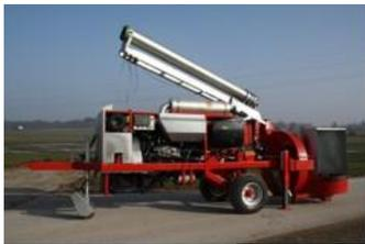
Mit der hydraulischen Rohrleitung als Zusatzausrüstung wird das Befüllen von Silos ohne fest montierte Leitung zum Kinderspiel.
