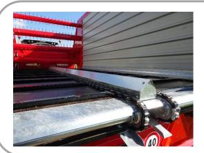
Die vier 12mm Kratzbodenketten sind stufenlos vor- und rückwärts laufend, sie gleiten über den Wagenboden der aus Kunstharzplatten besteht.
