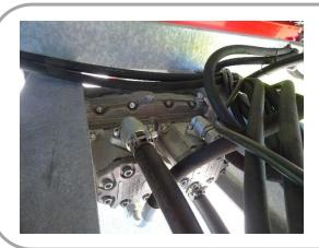
Die zwei Hydraulikpumpen treiben den Kratzboden, das Querband, sowie die Dosierwalzen hinten und vorne hydraulisch an.
