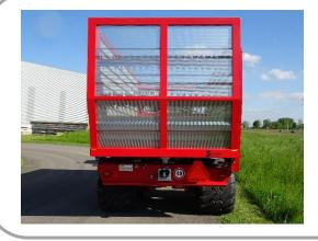
Der widerstandfähige Unterfahrschutz schützt das Fahrzeug.
