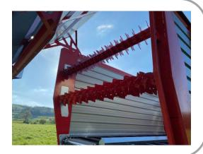
Durch die Frontklappe gelangt das Siliergut nicht in das Querband und somit wird ein herausfallen durch die Auswurföffnung verhindert.
