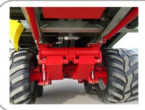
Das 16to Tandemfahrwerk ermöglicht auch in Hanglagen Standsicherheit. Die grosszügige Bereifung garantiert Bodenschonung.
