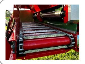
Das 60cm breite Querförderband mit grosser Fallstufe, sowie der geräumigen Auswurföffnung, wurden für eine beachtliche Abladeleistung gebaut.
