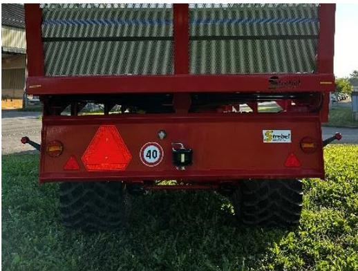
Der robuste Unterfahrerschutz schützt das Fahrzeug. Damit beim Rückwärts abladen kein Mais auf dem Lichterbalken liegen bleibt, wurde dieses spezielle Profil gewählt.
