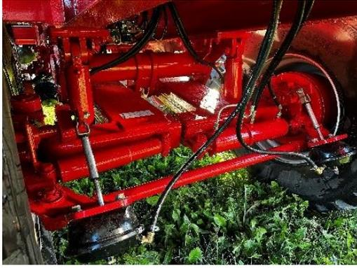
Das hydr.20to Tandemfahrwerk ermöglicht auch in Hanglagen Standsicherheit. Mit dem ausgeklügelten System lassen sich Reifenpannen ohne Winde und sogar auf dem Feld erledigen. Die grosszügige Bereifung garantiert Bodenschonung. Die grossdimensionierten Bremsen wirken auf alle vier Räder.
