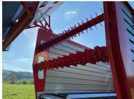
Durch die Frontklappe gelangt das Siliergut nicht in das Querband und somit wird ein Herausfallen durch die Auswurföffnung verhindert.
