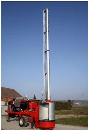
Die Tele-Rohrleitung ist durch den schnellen Aufbau sofort einsatzbereit. Die Höhe der Leitung ist je nach Silo flexibel einstellbar bis auf 11 Meter.
