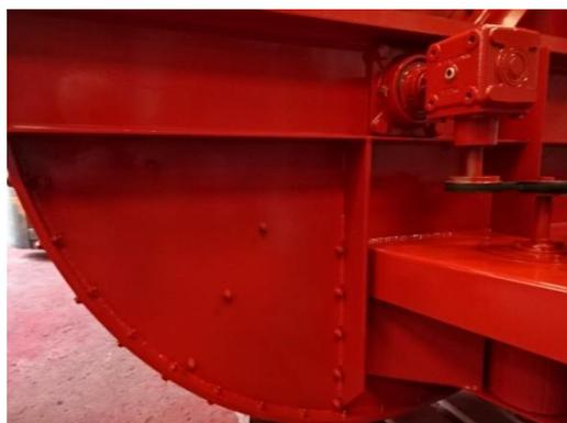
Durch den überarbeiteten Aufbau ist es möglich den geschraubten Verschleissboden von aussen auszuwechseln und einzustellen.
