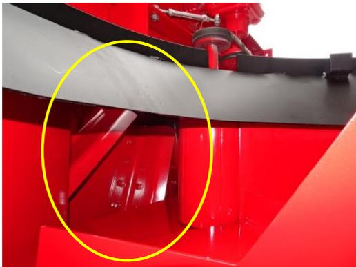
Das Fördergut wird mit Hilfe der aggressiven Zuführscheibe direkt im 40° Winkel in das Schaufelrad geworfen, wodurch es kein Richtungswechsel gibt, sondern eine Vorbeschleunigung die zusätzlich durch eine angetriebene Trommel unterstützt wird.
