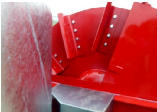
Unter dem leicht zu öffnenden Schaufelradgehäuse kommt das Schaufelrad mit den 12 robusten Wurfschaufeln zum Vorschein. Die Schaufeln sind stufenlos um ca. 20mm verstellbar und kennen keine Leistungsgrenze.
