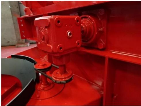
Die Beschleunigungstrommel wird mit einem Winkelgetriebe angetrieben.
