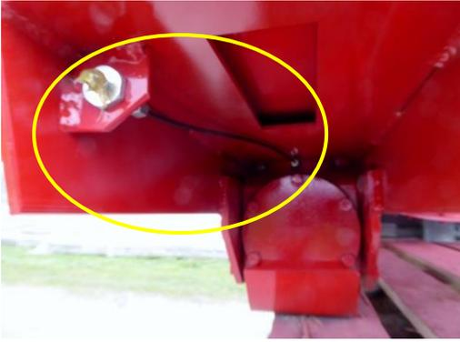
Das Getriebe der Zuführscheibe kann bequem über eine Schmierleitung geschmiert werden, was die Lebensdauer der Abdichtung um ein Vielfaches verlängert.
