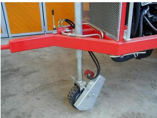
Das Stützrad kann hydraulisch ausgerüstet werden, durch diese Ausrüstung kann es angetrieben und gesenkt werden.
