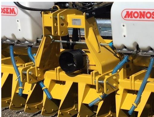
Mit dem 4-Ganggetriebe kann die Rotordrehzahl den äusseren Bedingungen optimal angepasst werden.
