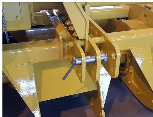
Der Dreipunktbau ist für Kat. 2 und 3 konstruiert, somit entstehen keine Probleme mit den Unterlenkern bei Breitbereifung.
