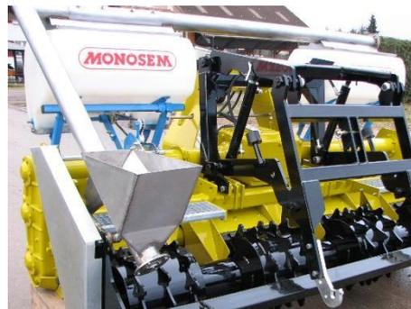
Wegen der einfachen Verstellung der Düngermenge ist es möglich zwischen 1Kg – 5 Kg Dünger gleichmässig zu dosieren.
