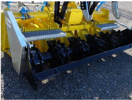
Die zwei Tritte ermöglichen einen einfacheren Aufstieg. Der Packer ist stufenlos verstellbar, was für spezielle Situationen von Vorteil ist.
