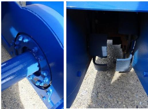
Mit Hilfe des grossen Rotordurchmessers und die doppelt geklemmte Messerbestfestigung gehört das Abscheren und lösen von Messerschrauben der Vergangenheit an. Infolge der mittig im Rotor angeordneten Grubberzinken und seiner speziell gerundeten Form reichen die Fräsmesser ca. 7cm vor den Grubberzinken, was eine problemlose Einarbeitung von Ernterückständen ermöglicht.
