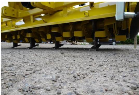
Der Rotor arbeitet auf einer Breite von 3.05m.
