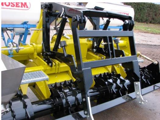
Der extrem stabile Hitch ist an das nachfolgende Dreipunktegerät einstellbar.
