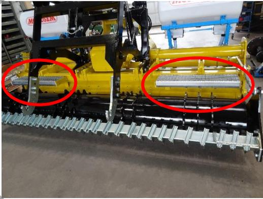
Die zwei Tritte ermöglichen einen einfacheren Aufstieg. Der Packer ist stufenlos verstellbar, was für extreme Situationen von Vorteil ist.
