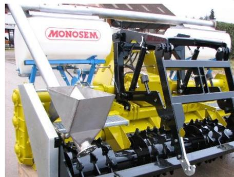
Durch die einfache Verstellung der Düngermenge ist es möglich zwischen 1Kg – 5 Kg gleichmässig zu dosieren.
