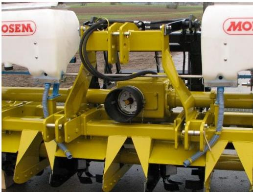
Die Rotordrehzahl kann mittels dem 4-Ganggetriebe optimal an den äusseren Bedingungen angepasst werden.
