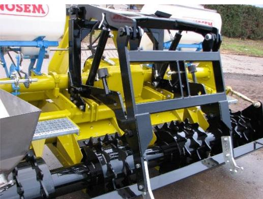
Der extrem stabile Hitch ist an das nachfolgende Dreipunktgerät einstellbar.
