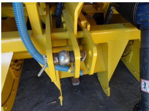
Dank dem Dreipunkteanbau, der spezifisch für die Kat. 2 und 3 entwickelt wurde, treten keine Probleme auf mit den Unterlenkern bei Breitbereitung.
