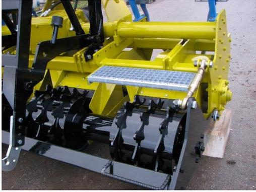
Infolge des abgesetzten Packers erreicht man eine bessere Rückverfestigung. Dadurch können die Seitenwände des Fräskanals nach hinten gezogen werden. Demzufolge ergibt sich eine exakte Randzone.
