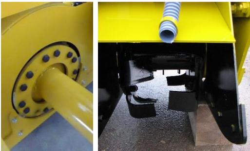
Mit Hilfe des grossen Rotordurchmessers und die doppelt geklemmte Messerbestfestigung gehört das Abscheren und lösen von Messerschrauben der Vergangenheit an.
