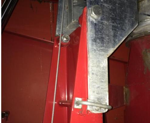
Aus Sicherheitsgründen wird der Hubmast mit einem Dorn gesichert. Das Rohr wird mit einer Rohrschelle zusammengehalten.
