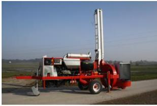
Die Leitung wird hydraulisch senkrecht aufgerichtet.
