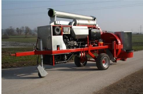
Die Rohrleitung ist in zusammengefahrenem Zustand platzsparend auf dem Dach des Gebläses montiert. Silos mit einer Standleitung können trotzdem ohne Mühe befüllt werden.
