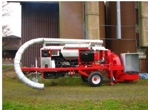
Der Rohrbogen wird am Boden montiert. Wenn die Leitung steht wird er von Hand in die richtige Position gebracht.
