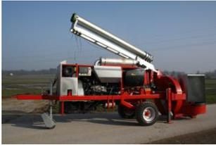
Die Leitung wird hydraulisch senkrecht aufgerichtet.
