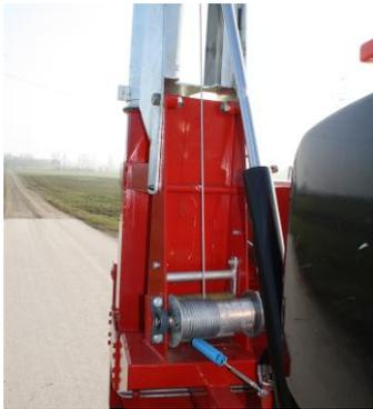
Danach wird sie mit einer Winde aufgezogen. Die Höhe kann stufenlos eingestellt werden.
