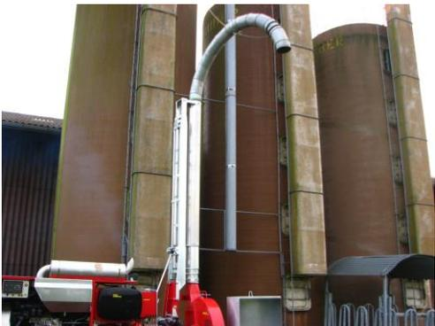
Die Höhe ist stufenlos verstellbar. Die max. Höhe beträgt 11m. Um höhere Silos zu befüllen können noch weitere Rohre montiert werden.
